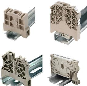
바이드뮬러 제품군에는 단자대 레일에 영구적이고 안정적으로 마운트될 수 있도록 보장하고 미끄러짐을 방지하는 엔드 브래킷이 포함되어 있습니다. 스크류가 포함 또는 포함되지 않은 버전을 사용할 수 있습니다. 엔드 브래킷에는 마킹 옵션(그룹 마커용 포함)과 테스트 플러그 헤더가 포함되어 있습니다.
