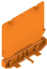
RS 100 Profi는 DIN 레일 설치와 벽면 설치가 모두 가능하기 때문에, 설치 요구 사항에 맞는 유연한 솔루션을 제공합니다. 이러한 다재다능함 덕분에 다양한 환경과 애플리케이션에 쉽게 통합할 수 있습니다. 하우징은 유로카드 PCB 표준을 따릅니다. 프로파일을 원하는 크기로 잘라내어 특정 요건에 정확하게 맞출 수 있습니다. 특히 무거운 부품의 경우, 추가적인 잠금 다리를 사용하여 안정성을 높이고 설치의 안전성을 높일 수 있습니다. 또 다른 실용적인 기능은 커버 프로파일을 사용하여 큰 컴포넌트를 보호하는 옵션입니다.
