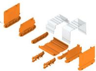
RS 100 Profi는 DIN 레일 설치와 벽면 설치가 모두 가능하기 때문에, 설치 요구 사항에 맞는 유연한 솔루션을 제공합니다. 이러한 다재다능함 덕분에 다양한 환경과 애플리케이션에 쉽게 통합할 수 있습니다. 하우징은 유로카드 PCB 표준을 따릅니다. 프로파일을 원하는 크기로 잘라내어 특정 요건에 정확하게 맞출 수 있습니다. 특히 무거운 부품의 경우, 추가적인 잠금 다리를 사용하여 안정성을 높이고 설치의 안전성을 높일 수 있습니다. 또 다른 실용적인 기능은 커버 프로파일을 사용하여 큰 콤포넌트를 보호하는 옵션입니다.
