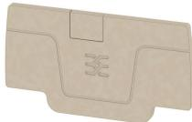
종판과 앤드 플레이트는 단자대의 필수 부속품입니다. 종판은 서로 다른 전위와 기능 그룹을 광학적으로 및 전기적으로 분리하여 안전성을 높이고 배전반 내부의 명확한 구조를 보장합니다. 앤드 플레이트는 측면의 단자대 열을 마감하고, 전류가 흐르는 부품과의 접촉을 방지하며, 깔끔하고 안정적인 마감을 보장합니다. 두 부품 모두 각각의 바이드뮐러 단자대 시리즈에 정확히 대응되어 안전하고 규정을 준수하며 전문적인 배선에 기여합니다.
