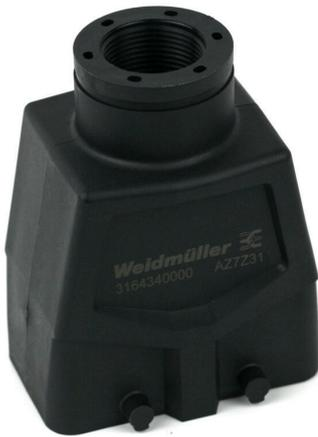
플라스틱 하우징은 금속의 저항이 충분하지 않은 애플리케이션에 특히 적합합니다. 또한 여기에 나와있는 외함은 표준 알루미늄 외함에 비해 가볍고 약간 더 저렴합니다. 따라서 견고한 재질이 필요하지 않은 애플리케이션에서는 플라스틱 외함을 사용하는 것이 합리적일 수 있습니다. 밀폐 등급은 IP65를 유지합니다.
