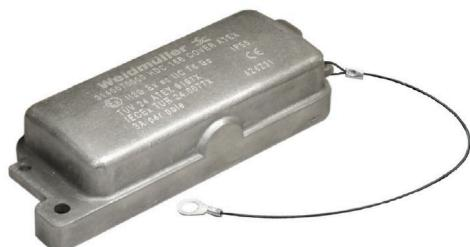
다음 승인을 준수하는 2구역에서 케이블을 분리할 수 있는 옵션 ATEX: T II 3G Ex ec IIC T6 Gc 또는 IECEX: Ex ec IIC T6 Gc는 설치 및 서비스를 간소화하고 더 나은 준비를 가능하게 합니다. 여기에서 제공되는 승인된 커넥터는 항상 해당 승인된 하우징 및 인서트와 함께 사용해야 하며 부하가 없는 상태에서만 분리할 수 있습니다.
