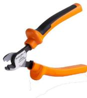
최대 외경 8 mm, 12 mm, 14 mm 및 22 mm 컨덕터용 절단 공구. 블레이드의 특수 기하학적 구조로 인해 최소한의 물리적 힘으로 구리 및 알루미늄 컨덕터를 핀칭 없이 절단할 수 있습니다. 이 절단 공구(KT 8~KT 22)는 VDE 및 GS 시험을 통과한 EN/IEC 60900 규격의 보호 절연(최대 1,000V)도 제공합니다.
