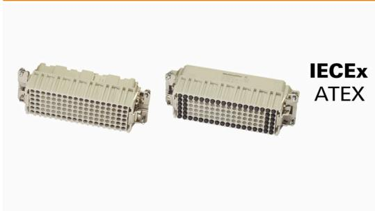
다음 승인을 준수하는 2구역에서 케이블을 분리할 수 있는 옵션 ATEX: T II 3G Ex ec IIC T6 Gc 또는 IECEX: Ex ec IIC T6 Gc는 설치 및 서비스를 간소화하고 더 나은 준비를 가능하게 합니다. 여기에서 제공되는 승인된 커넥터는 항상 해당 승인된 하우징 및 인서트와 함께 사용해야 하며 부하가 없는 상태에서에서만 분리할 수 있습니다.
