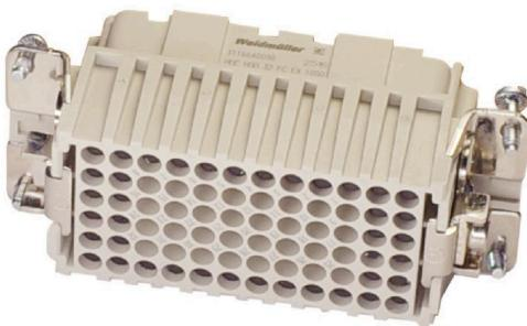
다음 승인을 준수하는 2구역에서 케이블을 분리할 수 있는 옵션 ATEX: T II 3G Ex ec IIC T6 Gc 또는 IECEX: Ex ec IIC T6 Gc는 설치 및 서비스를 간소화하고 더 나은 준비를 가능하게 합니다. 여기에서 제공되는 승인된 커넥터는 항상 해당 승인된 하우징 및 인서트와 함께 사용해야 하며 부하가 없는 상태에서만 분리할 수 있습니다.
