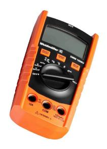
멀티미터는 여러 변수를 측정할 수 있습니다. 각 기기는 전압과 저항을 측정할 수 있으며, 표준에 따라 연속성과 다이오드 테스트를 수행할 수 있습니다. 또한, 개별 멀티미터로 전류, 주파수, 커패시턴스, 온도 등을 측정할 수도 있습니다. 디지털 멀티미터는 디스플레이를 통해 측정치를 쉽게 확인할 수 있다는 이점이 있습니다. 이러한 기기를 사용하면 측정 범위 변환 오류 또는
