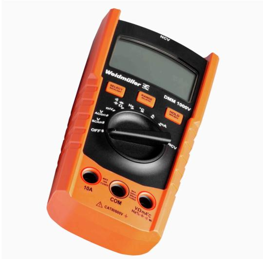
멀티미터는 여러 변수를 측정할 수 있습니다. 각 기기는 전압과 저항을 측정할 수 있으며, 표준에 따라 연속성과 다이오드 테스트를 수행할 수 있습니다. 또한, 개별 멀티미터로 전류, 주파수, 커패시턴스, 온도 등을 측정할 수도 있습니다. 디지털 멀티미터는 디스플레이를 통해 측정치를 쉽게 확인할 수 있다는 이점이 있습니다. 이러한 기기를 사용하면 측정 범위 변환 오류 또는 디스플레이 오판독에 따른 실수를 방지할 수 있습니다.
