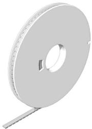
WS/ DEK MultiMark 단자대 마커는 2개의 구성 요소로 만들어진 혁신적 복합재를 사용합니다. 마커의 경질 하단부는 커넥터에 안전하게 고정됩니다. 표면을 탄성 소재로 마감하여 장착이 간편합니다. 특수 천공된 재질을 사용해 스트립은 간격에 발생하는 약간의 편차를 수용할 수 있도록 늘어납니다(이 편차는 늘어나는 경향이 있으며, 특히 긴 단자대 블록일 경우 그 정도가 큼). 추가 장점: 표면 재질은 탁월한 인쇄 적성으로 인해 내구성 및 내마모성이 뛰어난 라벨링을 보장합니다. 300 dpi의 인쇄 해상도로 가독성이 매우 좋은 글자를 출력합니다.
