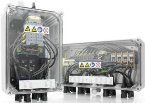
안전한 원격 종료를 위해 옥상 태양광 시스템에서 건물 내 전력망과 연결된 케이블이 건물 내부로 진입하는 지점에 단선 장치를 필요로 할 수 있습니다. 이렇게 하면 소방대가 불필요한 위험 없이 비상시 진화작업을 수행할 수 있습니다. 전원 공급 장치가 복원되면 PV Next Fireman 스위치가 자동으로 PV 스트링을 다시 연결합니다.
