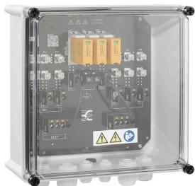
1 내지 12개의 MPP 추적기를 갖는 인버터에 대한 PV Next 접속함은 태양광 시스템의 DC 면을 보호하는데 사용됩니다. 접속함은 인버터를 과전압으로부터 보호하고 유럽 지침 CLC/TS 51643-32를 준수합니다. 또한, 이러한 제품은 시스템을 역류로부터 보호할 가능성과 설치 도중 케이블을 절약할 수 있도록 스트링을 결합시킬 수 있는 가능성을 제공합니다.
