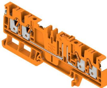
일부 응용 분야에서는 테스트 및 안전 목적을 위해 기본 연결 단자대에 테스트 포인트 또는 분리 요소를 추가하는 것이 좋습니다. 테스트 분리 단자대를 사용하여 전압이 없을 때 전기 회로를 측정할 수 있습니다. 분리 지점 이격 및 연면 거리는 치수와 관련하여 평가되지 않지만, 지정된 정격 임펄스 전압 강도를 입증해야 합니다.
