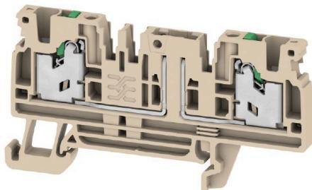
일부 응용 분야에서는 테스트 및 안전 목적을 위해 기본 연결 단자대에 테스트 포인트 또는 분리 요소를 추가하는 것이 좋습니다. 테스트 분리 단자대를 사용하여 전압이 없을 때 전기 회로를 측정할 수 있습니다. 분리 지점 이격 및 연면 거리는 치수와 관련하여 평가되지 않지만, 지정된 정격 임펄스 전압 강도를 입증해야 합니다.
