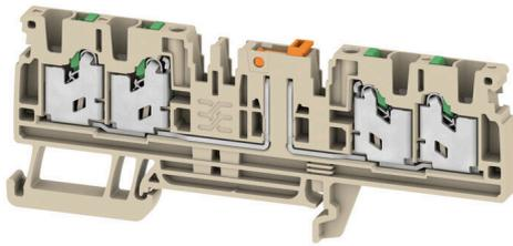
일부 응용 분야에서는 테스트 및 안전 목적을 위해 기본 연결 단자대에 테스트 포인트 또는 분리 요소를 추가하는 것이 좋습니다. 테스트 분리 단자대를 사용하여 전압이 없을 때 전기 회로를 측정할 수 있습니다. 분리 지점 이격 및 연면 거리는 치수와 관련하여 평가되지 않지만, 지정된 정격 임펄스 전압 강도를 입증해야 합니다.
