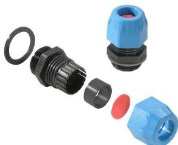
폴리아미드 케이블 글랜드는 폭발 위험 영역 Ex e (향상된 안전) 및 Ex i (본질 안전)에서 사용하기 적합합니다. 바이드뮬러는 제한 없이 제품군을 제공하며 표준 준수 외에도 케이블 글랜드는 4/7 줄의 향상된 충격 내성 및 제한 없이 -60°C까지 견딜 수 있는 폭넓은 온도 범위를 자랑합니다. 바이드뮬러 제품은 현행 기준 및 EN 60079-0 지침에 따른 시험을 거쳤으며, ATEX와 IECEx 인증도 획득했습니다.
