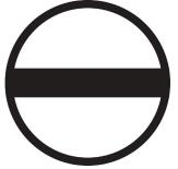
VDE 절연 일자 스크류드라이버, SDI DIN 7437, ISO 2380/2, DIN 5264, ISO 2380/1에 따른 드라이브 출력. SoftFinish 그림
