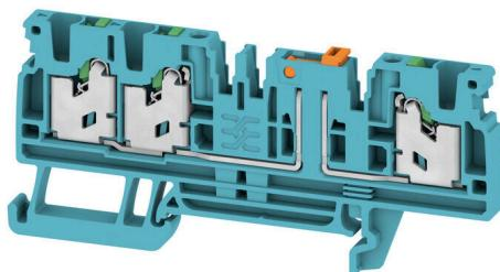
일부 응용 분야에서는 테스트 및 안전 목적을 위해 기본 연결 단자대에 테스트 포인트 또는 분리 요소를 추가하는 것이 좋습니다. 테스트 분리 단자대를 사용하여 전압이 없을 때 전기 회로를 측정할 수 있습니다. 분리 지점 이격 및 연면 거리는 치수와 관련하여 평가되지 않지만, 지정된 정격 임펄스 전압 강도를 입증해야 합니다.
