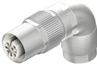
최근에는 각각 다양한 길이의 케이블이 종종 필요합니다. 이러한 요구를 충족할 수 있도록 바이드뮐러에서는 맞춤형 어셈블리를 위한 다양한 플러그 커넥터를 제공합니다. M8, M12, M16 및 7/8" 결선(탁월한 견고성으로 머신 엔지니어링 등에 이상적임)용 맞춤형 어셈블리를 위한 수형 플러그와 암형 소켓. M12 플러그 커넥터를 사용하는 경우 5가지의 결선형 중에서 선택할 수 있습니다. 크리프 결선은 기능적 안정성이 두드러집니다. 이 결선은 전선을 접점에 압착한 후 접점 캐리어에 물리는 방식입니다. 전선과 크리프 간의 결선은 진동에 강하고 오랜 시간 동안 안정적으로 유지됩니다. 크리프 접점은 별도로 주문하셔야 합니다.
