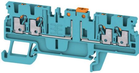
일부 응용 분야에서는 테스트 및 안전 목적을 위해 기본 연결 단자대에 테스트 포인트 또는 분리 요소를 추가하는 것이 좋습니다. 테스트 분리 단자대를 사용하여 전압이 없을 때 전기 회로를 측정할 수 있습니다. 분리 지점 이격 및 연면 거리는 치수와 관련하여 평가되지 않지만, 지정된 정격 임펄스 전압 강도를 입증해야 합니다.
