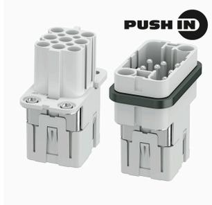
HQ 시리즈 - 컴팩트한 디자인에 숨겨진 놀라운 기능 전가 (electrical value)로 상태를 확인할 수 있습니다. 와이어 연결 레벨이 PUSH IN 접점용으로 설계되어 있습니다. 극 개수: 5, 8 정격 전류: 16 A 정격 전압: 250 V, 500 V
