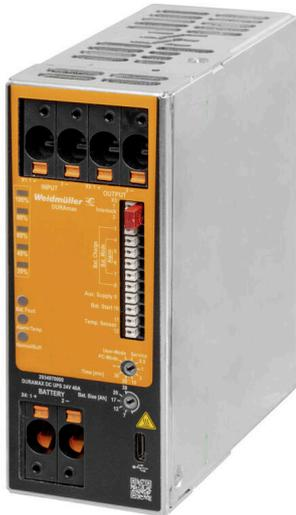
UPS 제어 유닛 및 연관된 모듈 그리고 전원 공급 장치가 전체 DC UPS 시스템을 구성합니다. 정상 작동 시에는 UPS 제어 유닛의 입력 전압이 부하에 직접 연결됩니다. 메인 전압이 실패하면(DC 입력 전압의 강하) 시스템이 즉시 배터리 작동으로 전환됩니다. 메인 전압이 복구되면 시스템은 다시 정상 작동으로 전환되고 배터리가 통합 충전기에 의해 완전히 재충전됩니다.
