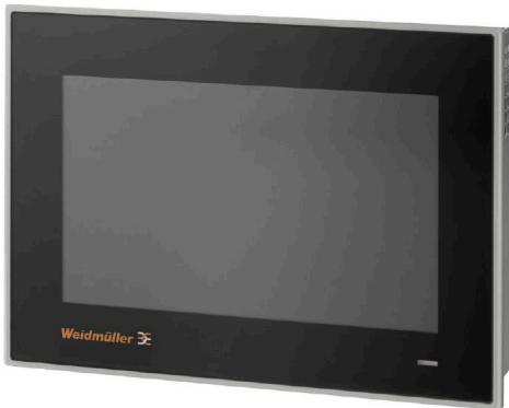
바이드뮬러의 u-view Advanced 터치 패널은 탁월한 영상 품질을 제공하며 대부분의 산업 환경에서 사용할 수 있습니다. 이 포트폴리오는 7"에서 21.5"까지 다양한 화면 사이즈가 특징으로, 스와이프 제스처와 글러브 작동을 지원하는 고해상도 정전용량식 터치스크린이 탑재되어 있습니다. 모든 패널에는 Linux 운영 체제와 HTML5 지원 브라우저가 탑재되어 있으며, 일체형 키오스크 모드와 간편한 구성으로 웹 애플리케이션에 최적화되어 있습니다. 따라서 웹 기반 시각화 용도로 최적의 솔루션이며, u-OS, u-create PROCON-WEB, u-control web 등 다양한 웹서버 액세스에 적합합니다. 패널은 산업용 IP66 하우징을 채용한 평면 디자인이 특징입니다.
