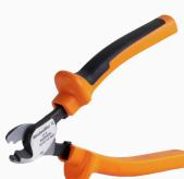
최대 외경 8 mm, 12 mm, 14 mm 및 22 mm 컨덕터용 절단 공구. 블레이드의 특수 기하학적 구조로 인해 최소한의 물리적 힘으로 구리 및 알루미늄 컨덕터를 핀침 없이 절단할 수 있습니다. 이 절단 공구(KT 8~KT 22)는 VDE 및 GS 시험을 통과한 EN/IEC 60900 규격의 보호 절연(최대 1,000V)도 제공합니다.
