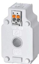
CMA-CTM 7 시리즈 미니 전류 변압기는 유도형 전류 변압기로, 원형 1차 컨덕터용 변압기 원칙에 따라 설계된 제품입니다. CMA-CTM 7 시리즈 전류 변압기는 유지보수가 필요 없고 32A부터 64A 범위에서 1차 전류를 측정하도록 설계된 제품입니다. 이 전류는 2차측에서 최대 1A의 전류로 변환됩니다. 크기가 작아 상 분리가 17.5mm인 3상 회로 차단기 내 사용 용도로 이상적입니다.
