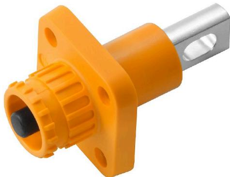
배터리 저장 시스템은 재생 에너지 분야에서 점점 더 중요한 역할을 하고 있습니다. 이들은 일반적으로 빠르고 쉽게 교체해야 하는 여러 개의 개별 배터리로 구성됩니다. 바이드뮬러 배터리 커넥터(WBC)를 사용하면 몇 가지 간단한 단계만으로 여러 개의 개별 배터리를 ESS에 연결하고 필요한 경우 연결을 신속하게 분리할 수 있습니다. 더욱 안전하고 쉽게 충급할 수 있도록 극이 분명하게 표시되어 있습니다. 양극은 주황색이고 음극은 검은색입니다.
