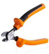
최대 외경 8 mm, 12 mm, 14 mm 및 22 mm 컨덕터용 절단 공구. 블레이드의 특수 기하학적 구조로 인해 최소한의 물리적 힘으로 구리 및 알루미늄 컨덕터를 핀침 없이 절단할 수 있습니다. 이 절단 공구(KT 8~KT 22)는 VDE 및 GS 시험을 통과한 EN/IEC 60900 규격의 보호 절연(최대 1,000V)도 제공합니다.
