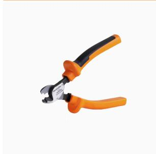
최대 외경 8 mm, 12 mm, 14 mm 및 22 mm 컨덕터용 절단 공구. 블레이드의 특수 기하학적 구조로 인해 최소한의 물리적 힘으로 구리 및 알루미늄 컨덕터를 핀칭 없이 절단할 수 있습니다. 이 절단 공구(KT 8~KT 22)는 VDE 및 GS 시험을 통과한 EN/IEC 60900 규격의 보호 절연(최대 1,000V)도 제공합니다.
