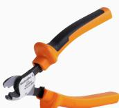
최대 외경 8 mm, 12 mm, 14 mm 및 22 mm 컨덕터용 절단 공구. 블레이드의 특수 기하학적 구조로 인해 최소한의 물리적 힘으로 구리 및 알루미늄 컨덕터를 핀침 없이 절단할 수 있습니다. 이 절단 공구(KT 8~KT 22)는 VDE 및 GS 시험을 통과한 EN/IEC 60900 규격의 보호 절연(최대 1,000V)도 제공합니다.
