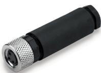
최근에는 각각 다양한 길이의 케이블이 종종 필요합니다. 이러한 요구를 충족할 수 있도록 바이드뮬러에서는 맞춤형 어셈블리를 위한 다양한 플러그 커넥터를 제공합니다. M8, M12, M16 및 7/8" 결선(탁월한 견고성으로 머신 엔지니어링 등에 이상적임)용 맞춤형 어셈블리를 위한 수형 플러그와 암형 소켓. M8 원형 플러그 커넥터는 특히 공간에 제약이 있는 경우 적합합니다. 스크류 결선은 광범위한 용도에 사용할 수 있습니다. 이 결선은 전선(선택적으로 페럴 사용)을 결선 요소에 끼우고 스크류로 조이는 방식입니다. 가장 경제적이고 일반적인 결선 방식으로, 이 방식은 다중 도체에 대한 결선도 지원합니다.
