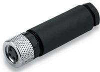
최근에는 각각 다양한 길이의 케이블이 종종 필요합니다. 이러한 요구를 충족할 수 있도록 바이드뮐러에서는 맞춤형 어셈블리를 위한 다양한 플러그 커넥터를 제공합니다. M8, M12, M16 및 7/8" 결선(탁월한 견고성으로 머신 엔지니어링 등에 이상적임)용 맞춤형 어셈블리를 위한 수형 플러그와 암형 소켓. M8 원형 플러그 커넥터는 특히 공간에 제약이 있는 경우 적합합니다. 스크류 결선은 광범위한 용도에 사용할 수 있습니다. 이 결선은 전선(선택적으로 페럴 사용)을 결선 요소에 끼우고 스크류로 조이는 방식입니다. 가장 경제적이고 일반적인 결선 방식으로, 이 방식은 다중 도체에 대한 결선도 지원합니다.
