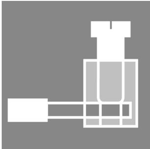
최근에는 각각 다양한 길이의 케이블이 종종 필요합니다. 이러한 요구를 충족할 수 있도록 바이드뮐러에서는 맞춤형 어셈블리를 위한 다양한 플러그 커넥터를 제공합니다. M8, M12, M16 및 7/8" 결선(탁월한 견고성으로 머신 엔지니어링 등에 이상적임)용 맞춤형 어셈블리를 위한 수형 플러그와 암형 소켓. M12 플러그 커넥터를 사용하는 경우 5가지의 결선형 중에서 선택할 수 있습니다. 스크류 결선은 광범위한 용도에 사용할 수 있습니다. 이 결선은 전선(선택적으로 페럴 사용)을 결선 요소에 끼우고 스크류로 조이는 방식입니다. 가장 경제적이고 일반적인 결선 방식으로, 이 방식은 다중 도체에 대한 결선도 지원합니다.
