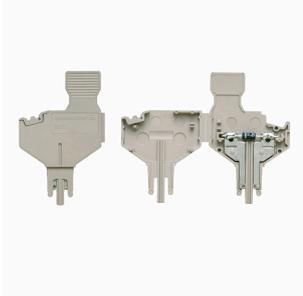
컴포넌트 플러그는 분리 단자대 블록에 전기 컴포넌트를 통합하는 데 사용됩니다. 전자 컴포넌트를 납땀한 후 플러그를 분리 단자대 블록의 분리 영역에 통합할 수 있으므로 분리 단자대 블록을 전자 부품이 통합된 모듈식 단자대로 변경합니다.
