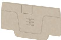
종판과 엔드 플레이트는 단자대의 필수 부속품입니다. 종판은 서로 다른 전위와 기능 그룹을 광학적으로 및 전기적으로 분리하여 안전성을 높이고 배선반 내부의 명확한 구조를 보장합니다. 엔드 플레이트는 측면의 단자대 열을 마감하고, 전류가 흐르는 부품과의 접촉을 방지하며, 깔끔하고 안정적인 마감을 보장합니다. 두 부품 모두 각각의 바이드몰러 단자대 시리즈에 정확히 대응되어 안전하고 규정을 준수하며 전문적인 배선에 기여합니다.
