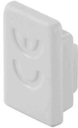
엔드 캡 및 커버는 버스 바를 길이로 절단한 후 또는 독립형 접점인 경우에도 시스템에서 필요한 연면 거리를 보장하며, DIN EN 50274에 따라 손가락 안전을 보장합니다.
