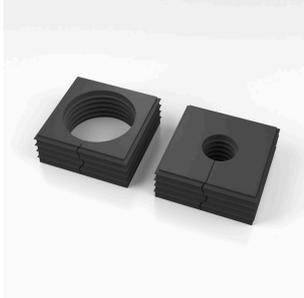
Cabtite는 케이블 직경에 구애받지 않고 언제나 적합한 실 인서트를 제공합니다. 씰링 요소는 원뿔 형태로 되어 있어 기존에 배치되어 있는 스냅인 방식을 그리드 인레이를 안에서 밖으로 쉽게 밀어낼 수 있습니다. 중간 공간을 확실하게 밀봉해 주고 DIN EN 62444에 따라 스트레인 해소 기능을 제공합니다. 실 인서트는 프레임과 함께 IP 66 등급의 보호를 제공합니다. 웨이브 절삭 가공된 슬롯형 디자인으로 인해 선조립 케이블에 특히 적합합니다.
