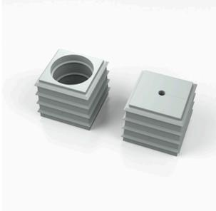
Cabtite는 케이블 직경에 구애받지 않고 언제나 적합한 실 인서트를 제공합니다. 실링 요소는 원뿔 형태로 되어 있어 기존에 배치되어 있는 스냅인 방식을 그리드 인레이를 안에서 밖으로 쉽게 밀어낼 수 있습니다. 중간 공간을 확실하게 밀봉해 주고 DIN EN 62444에 따라 스트레인 해소 기능을 제공합니다. 실 인서트는 프레임과 함께 IP 66 등급의 보호를 제공합니다. 웨이브 절삭 가공된 슬롯형 디자인으로 인해 선조립 케이블에 특히 적합합니다.
