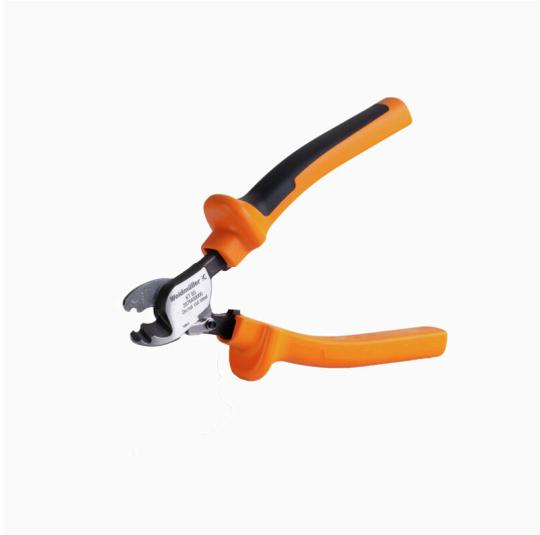
최대 외경 8 mm, 12 mm, 14 mm 및 22 mm 컨덕터용 절단 도구. 블레이드의 특수 기하학적 구조로 인해 최소한의 물리적 힘으로 구리 및 알루미늄 컨덕터를 핀칭 없이 절단할 수 있습니다. 이 절단 도구(KT 8~KT 22)는 VDE 및 GS 시험을 통과한 EN/IEC 60900 규격의 보호 절연(최대 1,000V)도 제공합니다.
