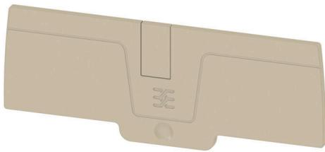
종판과 엔드 플레이트는 단자대의 필수 부속품입니다. 종판은 서로 다른 전위와 기능 그룹을 광학적으로 및 전기적으로 분리하여 안전성을 높이고 배전반 내부의 명확한 구조를 보장합니다. 엔드 플레이트는 측면의 단자대 열을 마감하고, 전류가 흐르는 부품과의 접촉을 방지하며, 깔끔하고 안정적인 마감을 보장합니다. 두 부품 모두 각각의 바이드물러 단자대 시리즈에 정확히 대응되어 안전하고 규정을 준수하며 전문적인 배선에 기여합니다.
