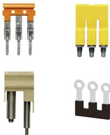
인접한 단자대에 전위를 분배 또는 증가시키는 것은 교차 연결을 통해 구현됩니다. 추가적인 결선 노력을 쉽게 피할 수 있습니다. 풀이 분리되더라도 단자대 블록의 접점 안정성은 여전히 보장됩니다. 당사의 포트폴리오는 모듈형 터미널 블록을 위한 플러그형 및 스크루형 점프바 시스템을 제공합니다.
