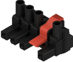
IT 전력 네트워크를 위한 7.62 피치가 있는 180° 암형 플러그 UL1059 600 V 클래스 C의 요구사항을 충족합니다. 수형 헤더 SL 7.62 IT와 함께 사용 리드 접점 포함 400 V에서 접지까지의 IT 전력 네트워크를 위한 5.5 mm 접촉 안전성에 대한 IEC 61800-5-1의 강화된 요건을 충족. 스크류 고정도 가능한 자가 잠금식 중간 플랜지는 기존의 솔루션에 비해 차지하는 공간을 1 피치 폭만큼 절약해 줍니다. 요청 시 중간 플랜지 연동장치 없이 제공 가능합니다.
