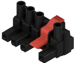
IT 전력 네트워크를 위한 7.62 피치가 있는 180° 암형 플러그 UL1059 600 V 클래스 C의 요구사항을 충족합니다. 수형 헤더 SL 7.62 IT와 함께 사용 리드 접점 포함 400 V에서 접지까지의 IT 전력 네트워크를 위한 5.5 mm 접촉 안전성에 대한 IEC 61800-5-1의 강화된 요건을 충족. 스크류 고정도 가능한 자가 잠금식 중간 플랜지는 기존의 솔루션에 비해 차지하는 공간을 1 피치 폭만큼 절약해 줍니다.
