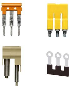
인접한 단자대에 전위를 분배 또는 증가시키는 것은 교차 연결을 통해 구현됩니다. 추가적인 결선 노력을 쉽게 피할 수 있습니다. 폴이 분리되더라도 단자대 블록의 접점 안정성은 여전히 보장됩니다. 당사의 포트폴리오는 모듈형 터미널 블록을 위한 플러그형 및 스크루형 점프바 시스템을 제공합니다.
