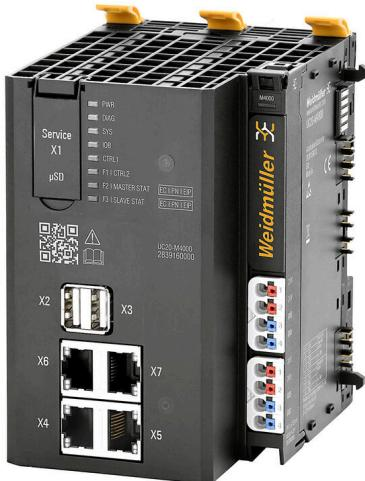
u-control M3000을 사용하면 자동화 솔루션을 IoT에 완벽하게 통합할 수 있습니다. 강력한 컨트롤러는 네트워크에서 로컬 정보를 제공하는 엣지 장치로도 작동하며, 자동화 및 IIoT 응용 분야에 적합한 기능 모듈을 연결하여 확장할 수 있습니다. u-control M4000은 2개의 추가 CPU 코어, 2개의 이더넷 인터페이스 및 자동화의 복잡한 엣지 컴퓨팅을 위한 RAM, NV RAM 및 플래시 메모리를 제공합니다.
