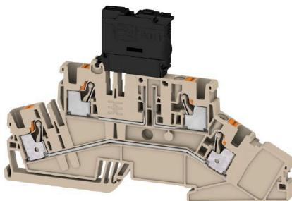
일부 응용 분야에서는 별도의 퓨즈로 연결하여 피드를 보호하는 것이 유용합니다. 퓨즈 단자대는 퓨즈 삽입 캐리어가 있는 하나의 단자대 하단 섹션으로 구성됩니다. 퓨즈는 피벗 퓨즈 레버 및 플러그형 퓨즈 홀더에서 스크류형 클로저 및 플랫 플러그인 퓨즈에 이르기까지 다양합니다.
