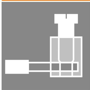
최근에는 각각 다양한 길이의 케이블이 종종 필요합니다. 이러한 요구를 충족할 수 있도록 바이드물러에서는 맞춤형 어셈블리를 위한 다양한 플러그 커넥터를 제공합니다. M8, M12, M16 및 7/8" 결선(탁월한 견고성으로 머신 엔지니어링 등에 이상적임)용 맞춤형 어셈블리를 위한 수형 플러그와 암형 소켓. M12 플러그 커넥터를 사용하는 경우 5가지의 결선형 중에서 선택할 수 있습니다. 스크류 결선은 광범위한 용도에 사용할 수 있습니다. 이 결선은 전선(선택적으로 페럴 사용)을 결선 요소에 끼우고 스크류로 조이는 방식입니다. 가장 경제적이고 일반적인 결선 방식으로, 이 방식은 다중 도체에 대한 결선도 지원합니다.
