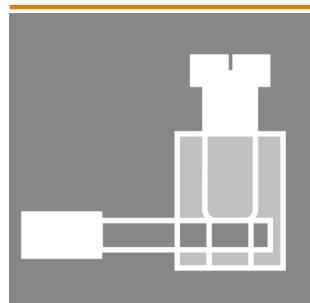
최근에는 각각 다양한 길이의 케이블이 종종 필요합니다. 이러한 요구를 충족할 수 있도록 바이드뮬러에서는 맞춤형 어셈블리를 위한 다양한 플러그 커넥터를 제공합니다. M8, M12, M16 및 7/8" 결선(탁월한 견고성으로 머신 엔지니어링 등에 이상적임)용 맞춤형 어셈블리를 위한 수형 플러그와 암형 소켓. M12 플러그 커넥터를 사용하는 경우 5가지의 결선형 중에서 선택할 수 있습니다. 스크류 결선은 광범위한 용도에 사용할 수 있습니다. 이 결선은 전선(선택적으로 페럴 사용)을 결선 요소에 끼우고 스크류로 조이는 방식입니다. 가장 경제적이고 일반적인 결선 방식으로, 이 방식은 다중 도체에 대한 결선도 지원합니다.
