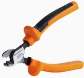
최대 외경 8 mm, 12 mm, 14 mm 및 22 mm 컨덕터용 절단 공구. 블레이드의 특수 기하학적 구조로 인해 최소한의 물리적 힘으로 구리 및 알루미늄 컨덕터를 핀칭 없이 절단할 수 있습니다. 이 절단 공구(KT 8~KT 22)는 VDE 및 GS 시험을 통과한 EN/IEC 60900 규격의 보호 절연(최대 1,000V)도 제공합니다.
