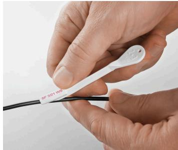
SlimFix는 공간 절약형 설계의 도체 및 케이블 마커입니다. 도체가 설치된 후라도 마커를 피팅할 수 있습니다. 무할로겐 소재를 사용했으며 난연 등급 VO/V2 적합 제품입니다. SlimFix는 교통 엔지니어링 응용 분야에 널리 알려지고 입증된 마커 유형입니다. SF 공구를 사용하면 소형 마커의 경우라도 손쉬운 설치가 가능합니다.
