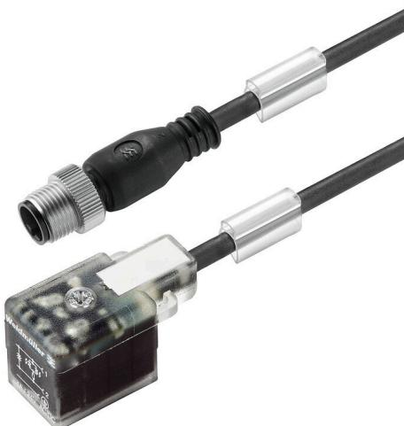
바이드뮬러에서는 M8/M12 플러그와 커넥터 없는 종단이 적용된 결선 라인으로 밸브 플러그를 제공할 수 있습니다. 밸브 플러그의 상태는 LED로 표시됩니다. 밸브 플러그에는 보호 회로가 있습니다. 바이드뮬러 제품군에는 밸브 플러그 유형 A, B 및 C 그리고 DIN과 산업 표준이 포함됩니다. 나사로 고정하면 보호 등급 IP 67이 총족됩니다. 아웃렛 방향도 중요한 요소이므로 바이드뮬러는 다양한 버전을 제공합니다.
