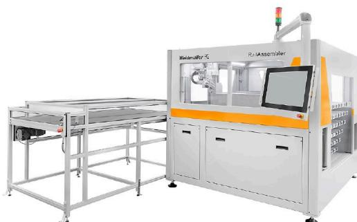
Klippon® Automated RailAssembler는 단자 스트립을 완전히 자동으로 조립할 수 있도록 해줍니다. 자동화 시스템을 바이드뮬러 구성기(WMC)와 함께 사용하면 생산 프로세스에서 개별 단자대를 선택, 할당 및 배치할 필요가 없습니다. 이러한 방식을 통해, 일반적인 조립에서 최대 60%의 시간을 절감할 수 있습니다. 무인 작업에서는 이 수치가 훨씬 더 커질 수 있습니다.
