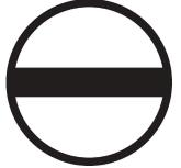
VDE 절연 일자 스크류드라이버, SDI DIN 7437, ISO 2380/2, DIN 5264, ISO 2380/1에 따른 드라이브 출력. SoftFinish 그림
